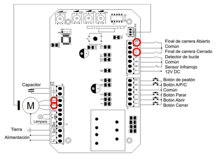
Para cambiar las direcciones del motor intercambie la posición de los siguientes cables:
