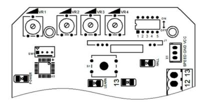
El cuadro de maniobras cuenta con 4 **potenciómetros**, del VR1 al VR4, y 5 **DIP SWITCH**, del DIP 1 al DIP 5. Tanto los potenciómetros como los DIP sirven para regular y ajustar ciertos parámetros de la puerta para contar con un buen ajuste para cada situación. A continuación se explicará el ajuste de cada parámetro.
