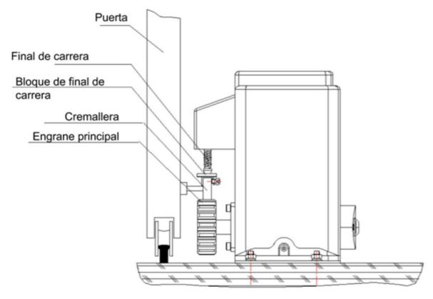
La instalación de topes físicos de final de carrera deben colocarse en la cremallera como se indica en la siguiente imagen.
